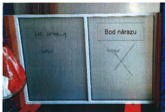
Obrázok č. 2 – zaťaženie rázom mäkkým nárazovým telesom po kontrolnom zaťažení
